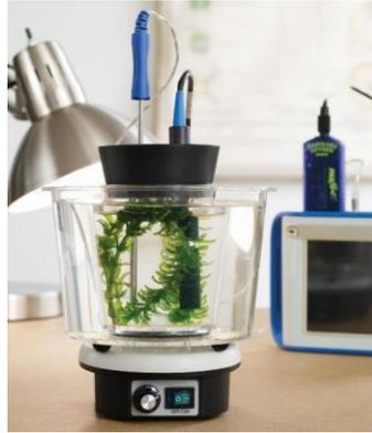
Grâce à un dispositif ExAO (Expérimentation assistée par ordinateur), on a enregistré avec deux sondes le taux d'O<sub>2</sub> et le taux de CO<sub>2</sub> présent dans l'eau autour de la plante. On a aussi, toutes les 5 min, mis la plante soit à la lumière (jour), soit à l'obscurité (nuit).
